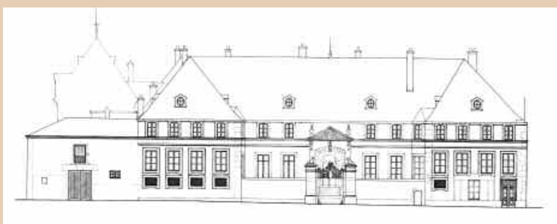
Élévation sur rue de l'hôtel des Loups montrant le portail clôturant la cour et l'extension du 19 e siècle à gauche.
